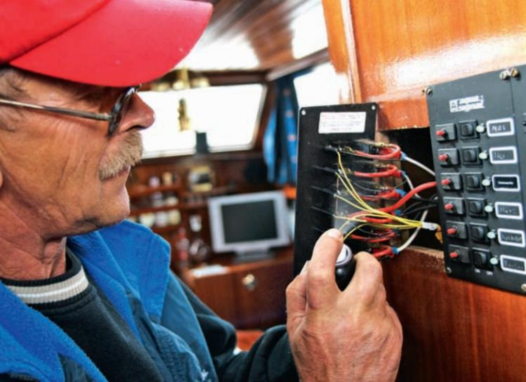
Schalter und Sicherungskästen: konservieren mit Kontaktspray.
