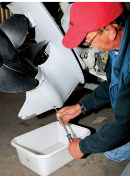
**Pflichtübung: das alte Öl ablassen und durch frisches ersetzen.**
