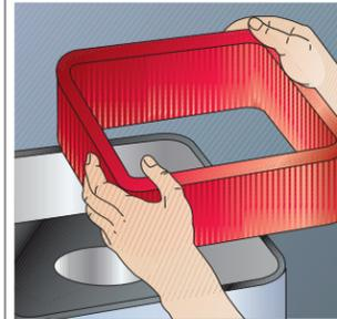
**Luftfilter:** je nach Bauart reinigen oder austauschen.
