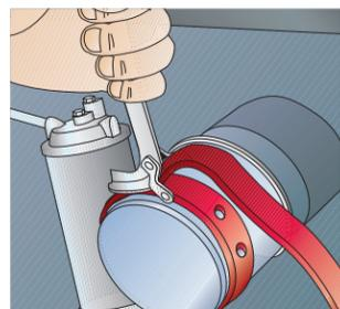
Ölfilter: Zum Lösen braucht man einen „Filterschlüssel“.
