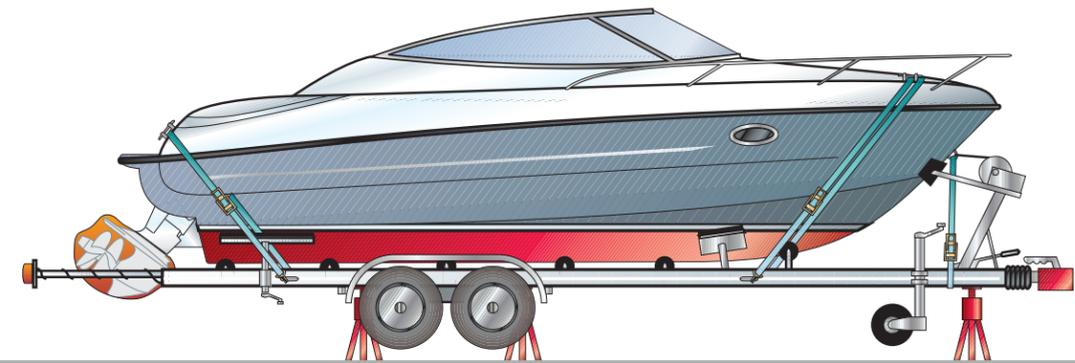
**Trailer: Im Winterlager sollen Achsen und Reifen entlastet werden.**
