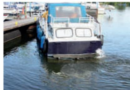
des Motors. Beim Rückwärtsfahren versetzt ein linksdrehender Propeller das Heck nach rechts (Steuerbord) und ein rechtsdrehender das Heck nach links (Backbord).
